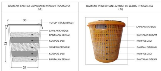
Gambar 1. Susunan Komponen Pada Wadah Takakura
