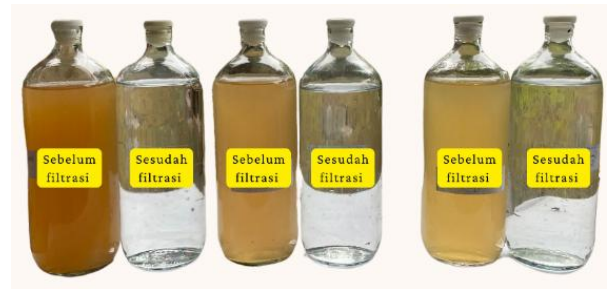
Gambar 4. Kondisi Sampel Air Sebelum dan Sesudah Proses Filtrasi
