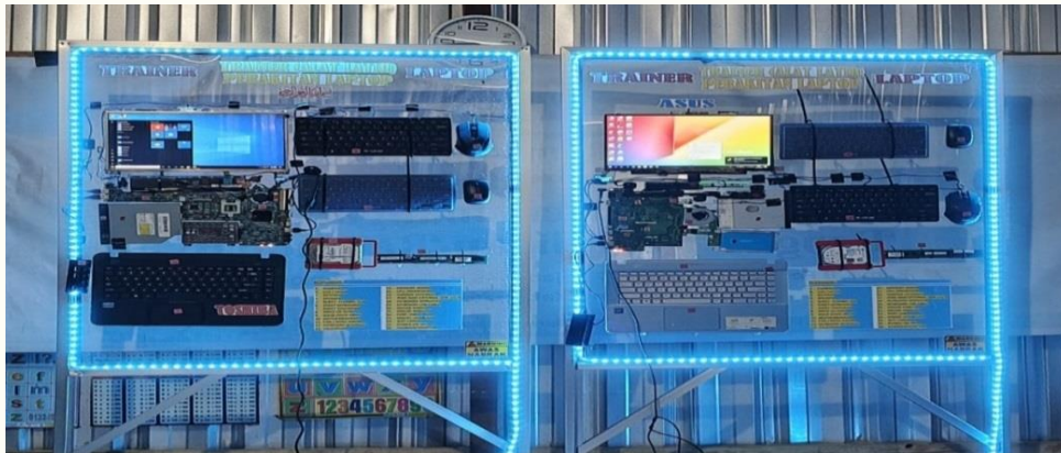
Gambar 2. Trainer Perakitan Laptop Type Toshiba (Kiri) dan Type Asus (Kanan)
