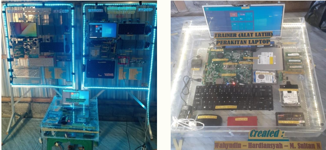
Gambar 2. Trainer (Alat latihan) Perakitan Laptop dengan 3 Variasi (Asus, Toshiba dan Acer)
