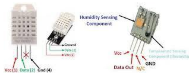
Gambar 2.1 : Sensor suhu dan kelembaban DHT22
